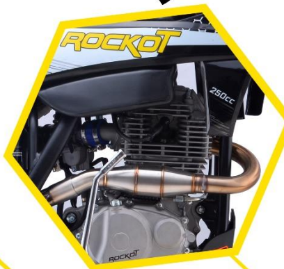
Выхлопная труба из нержавеющей стали с резонатором
